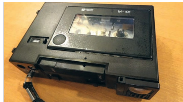
Kieszonkowy magnetofon M -101 Unitra Magmor. Wymiary: 150x103x40 mm, ciężar bez baterii 45 dkg.
